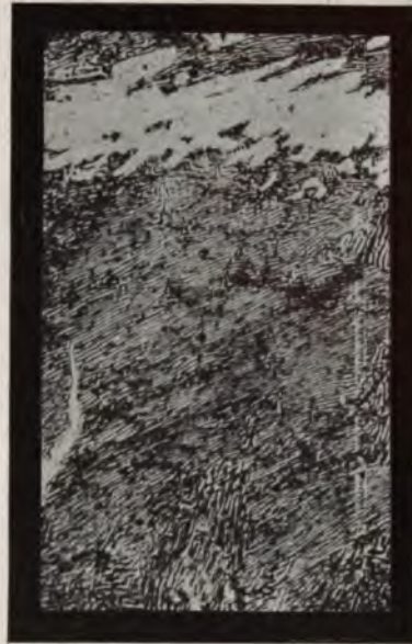
Fig. 132. Hyper-eutektischer Stahl. Freier Cementit umgeben von lamellarem Perlit.
